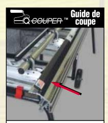
Fonctionne avec "Q-Cisailles" et "Q-Arrêt de cisailles". Aligne les marques de crayon aux cisailles à molettes.
