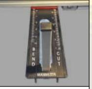
Dispositif de mesure réglable conçu pour les coupes et les pliages répétés. Il suffit de régler les dimensions. Aucun crayon nécessaire. Empile automatiquement toutes les pièces coupées sur les optimiseurs, évitant de les laisser tomber au sol. Vendus en lot de 4.
